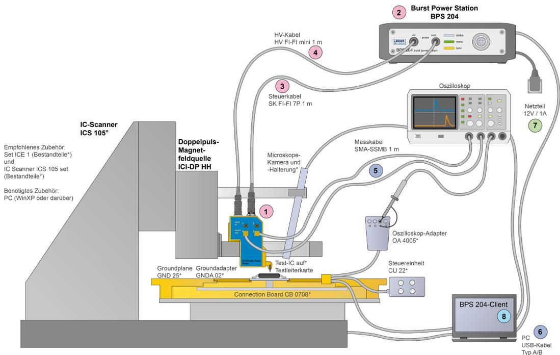
Messplatz Fault injection mit Langer IC-Scanner
